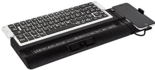
Der Activator ist eine komplette Neuentwicklung von HelpTech. Bewährtes, wie die konkaven Braillemodule und Erkennung der Leseposition in Echtzeit (ATC-Technologie) werden mit neuen Ideen kombiniert. Die Klapp tastatur ermöglicht die Punktschrift- und Texteingabe in Schwarzschrift. Trotzdem ist das Gehäuse nur 1.8cm hoch. Der Activator verfügt neu auch über eine integrierte Voll- und Kurzschrift Übersetzung (RTFC Braille-Konverter).
